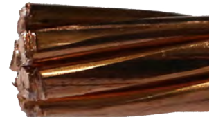
Taglio con forbici o tronchesine ordinarie. Ricordarsi di limare per rimuovere eventuali sbavature del metallo, seguendo il verso della cordatura.
