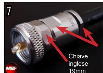
7 Inserire il connettore ed avvitarlo con cura, fino ad andare a serrare il componente A di battuta. All'interno del connettore, il cilindro di gomma C (figura 1) si espande garantendo un'ottimale tenuta contro l'umidità e una perfetta chiusura a massa.
