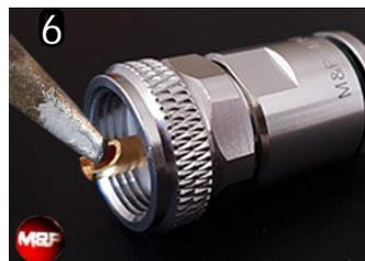
6 Inserire il connettore e successivamente saldare il conduttore centrale come in figura. Saldare lo spillo al conduttore centrale, inserendo stagno nell'apposito foro. Non scaldare troppo a lungo lo spillo per evitare che il rame sottostante conduca troppo calore tanto da deformare il dielettrico del cavo. (che è PE espanso e non in teflon!)
