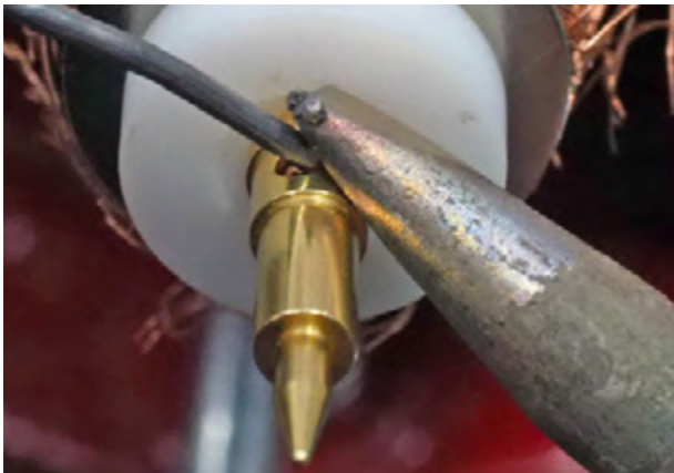
La saldatura deve essere il più veloce possibile: 2-3 secondi per i connettori "N".
